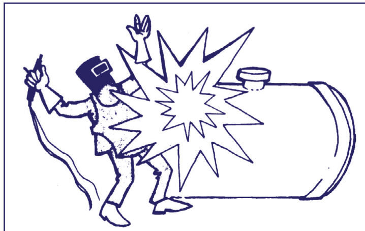
Fig. 1 - Explosion due à un dégazage incomplet
