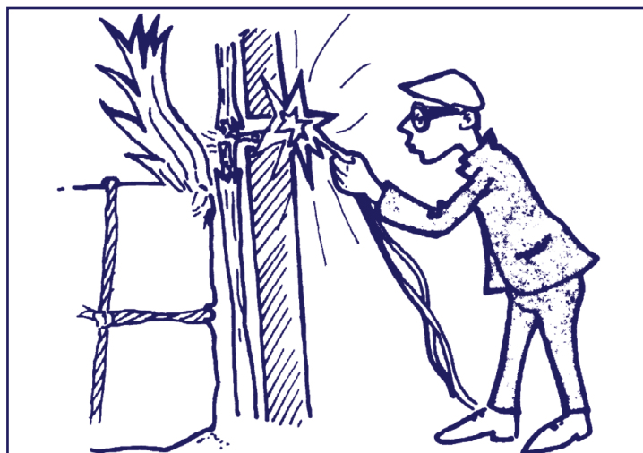
Fig. 2 - Inflammation au contact de conduites invisibles chauffées
